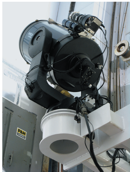
CCD kamera G1-0300 v primárním ohnisku komerčního 14" Schmidt-Cassegrain dalekohledu
